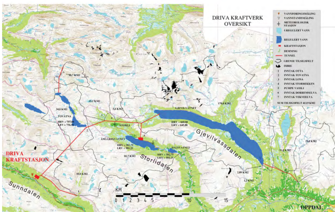
Kartskisse som viser Driva kraftverk. Vatn pumpes opp fra Angårdsvatnet til Gjevillvatnet. Kraftverket utnytter fallet fra Gjevillvatnet og ned til Sunndalen. Kart: TrønderEnergi
