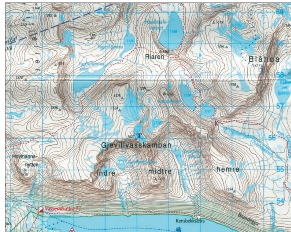
Turkartet gitt ut av Rindal i VEKST i målestokk 1:75 000 er meget lettlest. Både tjukkelse på høydekurver, markering av myrer, elver og vatn, fargetone på skog og markering av ruter er godt avstemt.
