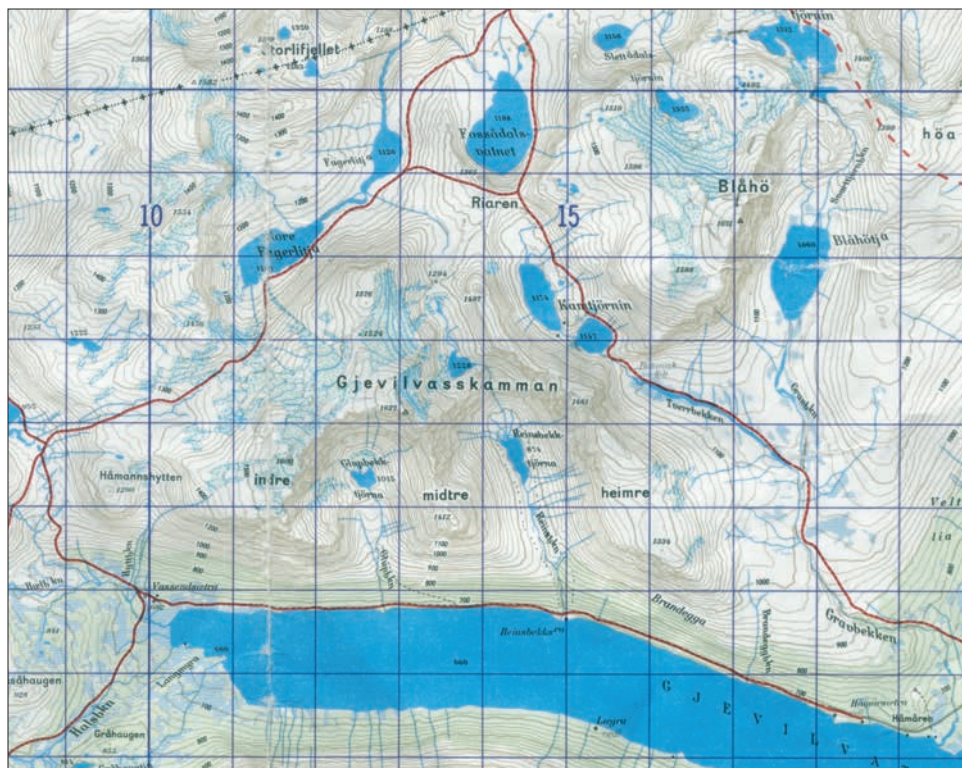
Turkartet over Trollheimen fra 1975 i målestokk 1:100 000 var en nedfotografering av de fire kartbladene i målestokk 1:50 000 for Trollhetta, Oppdal, Romfo og Snota.
